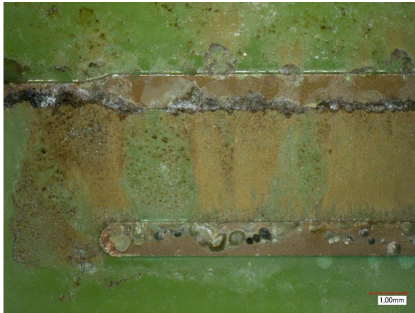
Abbildung 9: Prüfling 3 (Ausschnitt rotbraune Zonen zwischen Strombahnen)
