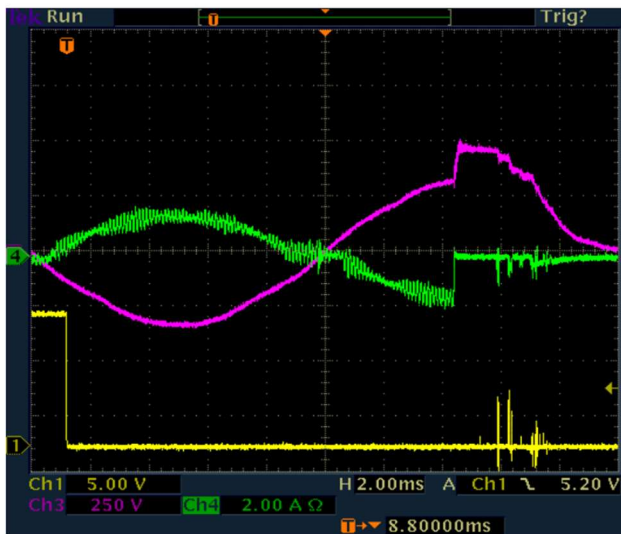
Abbildung 25: Ausschnitt aus dem vorigen Bild; der Strom wird sofort unterbrochen, die Spannung sinkt mit Entladewiderstand in etwa 4 ms auf 0 V.
